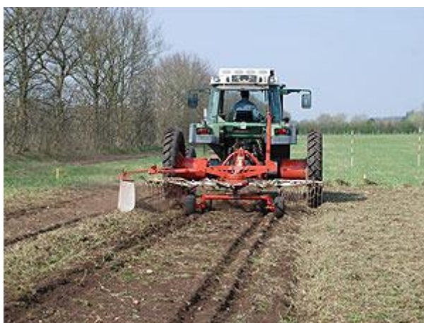
Rotorrive til sammenrivning af kvikudløbere. Mere kan ses på Youtube: http://www.youtube.com/watch?v=J_r8irY7NrA
