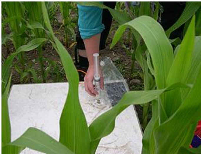
Figur1. Udledningen af \text{N}_2\text{O} blev målt ved hjælp af manuel gasprøve-tagning i gas-flux kamre.
